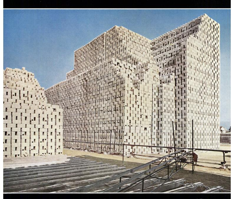
vereinigt in idealer Weise die Hauptfunktionen einer Aussenwand: Tragfähigkeit, Wetterschutz, Kälte- und Wärmeschutz, Schallschutz. Die erforderliche Tragfähigkeit entsprechend den Belastungen wird ausschliesslich durch Variation der Betonfestigkeit, in speziellen Fällen durch Einlagen von Eisenarmierungen herbeigeführt. Die Isolation wird daher weder auf Kosten der Tragfähigkeit noch die Festigkeit auf Kosten der Isolation erreicht.
