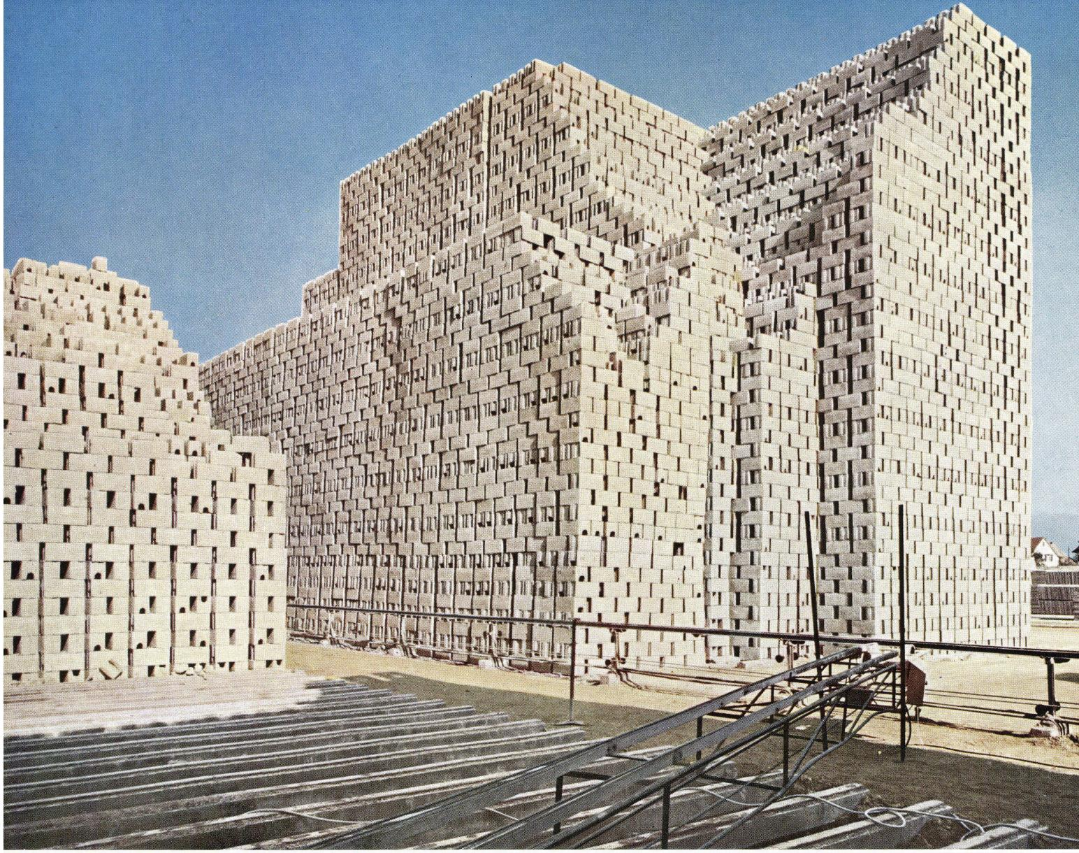
vereinigt in idealer Weise die Hauptfunktionen einer Aussenwand: Tragfähigkeit, Wetterschutz, Kälte- und Wärmeschutz, Schallschutz. Die erforderliche Tragfähigkeit entsprechend den Belastungen wird ausschliesslich durch Variation der Betonfestigkeit, in speziellen Fällen durch Einlagen von Eisenarmierungen herbeigeführt. Die Isolation wird daher weder auf Kosten der Tragfähigkeit noch die Festigkeit auf Kosten der Isolation erreicht.
