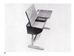
Abb.1. Schülertisch Gozet Bern und Schülerstuhl Gozet GE Geteilte Tischplatte aus Ahorn. – Bleistiftrinne mit Textolite oder Formica ausgelegt, reparaturfreie Klappenarretierung, Stahlrohrgestell aus Ovalrohr, höhenverstellbar, Gummifüße chemisch neutral auch auf Plastoböden. – Der Stuhl mit orthopädischem Sattelsitz, gewölbter Rückenlehne, Sperrholz, splitterfrei verleimt.
