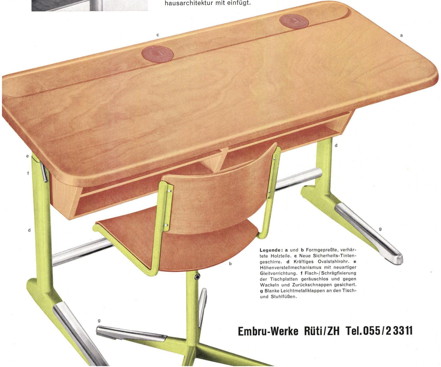
Legende: a und b Formgepreßte, verhärtete Holzteile. c Neue Sicherheits-Tintengeschirre. d Kräftiges Ovalstahlrohr. e Höhenstellmechanismus mit neuartiger Gleitvorrichtung. f Flach-/Schrägfixierung der Tischplatten geräuschlos und gegen Wackeln und Zurückschnappen gesichert. g Blanke Leichtmetallklappen an den Tisch- und Stuhlfüßen.
