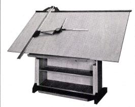
Neuer Zeichenständer «Rüedi», Modell B1, mit Laufwerk-Zeichenmaschine, Chassis mit Brett bis 30° stufenlos neigbar. Brett in jeder Stellung parallel zum Chassis verschiebbar. Minimale Platzbeanspruchung. Vorderseite: Ständer mit Tablar und bequemer Fußstütze. Anstellmöglichkeit gegen jedes Pult oder jeden Schreibtisch. Auch in Spezialausführungen erhältlich.
