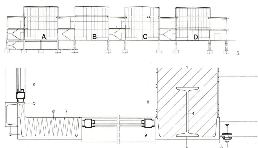
Konstruktionsdetail der Gebäudeecke und der Zwischenstütze mit Wandanschluß 1:8 aus obigem Bild.
