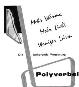
besteht aus zwei oder mehreren UNIVERBEL-Maschinenglasscheiben von vollkommener Klarheit, getrennt durch ein entfeuchtetes Luftpolster. Diese Scheiben sind am Rande mit einer patentierten Dichtung hermetisch abgeschlossen. Ausserdem wird die Einheit noch von einem Schutzrahmen aus rostfreiem Stahl umfasst, der ihr eine beachtenswerte Widerstandsfähigkeit verleiht.
