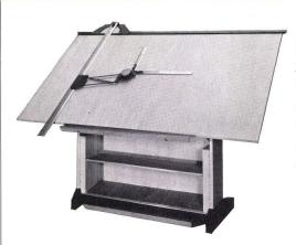
Neuer Zeichenständer «Rüedi», Modell B1, mit Laufwerk-Zeichenmaschine, Chassis mit Brett bis 30° stufenlos neigbar. Brett in jeder Stellung parallel zum Chassis verschiebbar. Minimale Platzbeanspruchung. Vorderseite: Ständer mit Tablar und beguemer Fußstütze. Anstellmöglichkeit gegen jedes Pult oder jeden Schreibtisch. Auch in Spezialausführungen erhältlich.
