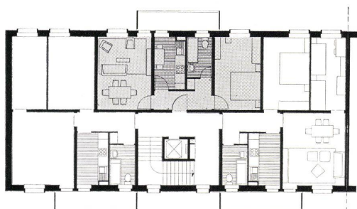
Grundriß des 19geschossigen Turmhauses mit Zwei- und Drei-Zimmerwohnungen
