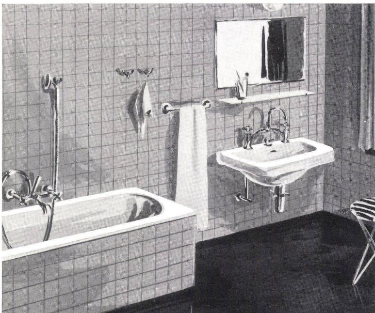
Balamur verlegt man so einfach wie eine Tapete. Es wird mit Balagum auf die Rohwand geklebt ... und hält! Da sich Balamur gut schneiden lässt, bereiten Aussparungen keine Schwierigkeiten.
