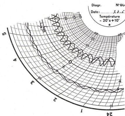
Anzeigung der Verdampfer-Temperatur und Thermostatschaltungen
