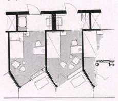
Grundriß von zwei Einbettzimmern / Plan de deux chambres d'hôtels à un lit / Ground plan of two single-
