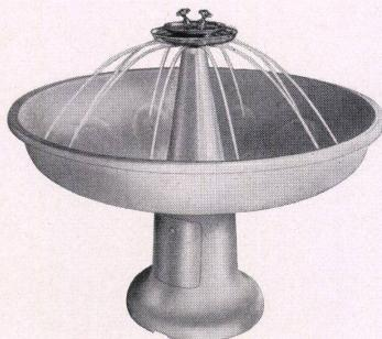
Dieser verblüffende Effekt der «Kuhn-Sanperla»-Fontänen wird dadurch erzielt, daß ihre Wasserstrahlen mit dem Luftsauerstoff maximal angereichert werden, was nach dem Injektorprinzip durch die Intensität des Wassers geschieht, wenn dieses die Sanperladüsen durchfließt. Es gibt dabei keinerlei rotierende Teile.
