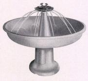
Dieser verblüffende Effekt der «Kuhn-Sanperla»-Fontänen wird dadurch er-zielt, daß ihre Wasserstrahlen mit dem Luftsauerstoff maximal angereichert werden, was nach dem Injektorprinzip durch die Intensität des Wassers geschieht, wenn dieses die Sanperladüsen durchfließt. Es gibt dabei keinerlei rotierende
