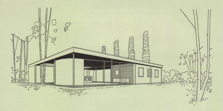
ten stehen Stahlsäulen, die das flache Betondach tragen. Die Ausfachung besteht zum Teil aus Mauerwerk, zum Teil aus Glas. Sie wird nach den jeweiligen Erfordernissen frei in den überdeckten Bereich gestellt und kann ohne Beeinflussung des konstruktiven Gefüges jederzeit verändert werden.
