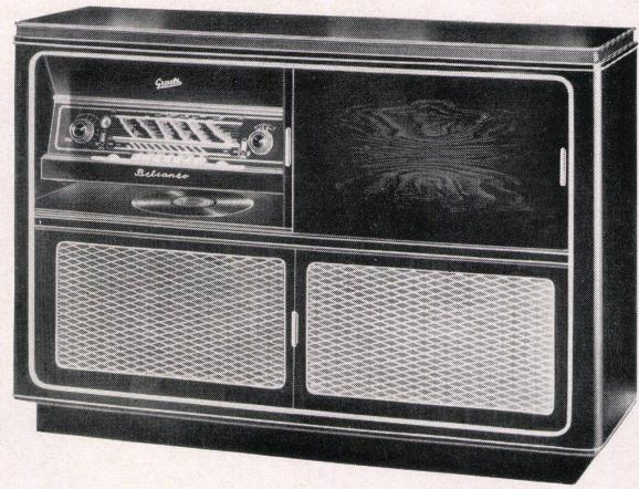
Spezialchassis: 8/13 Kreise, 10 Röhren, drehbare Ferritantenne, Sprache-Musik-Taste, 5 Lautsprecher.
