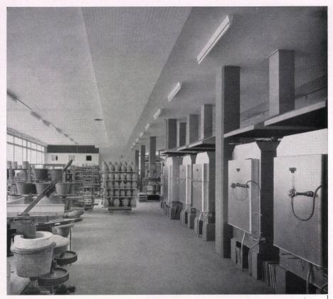
1 Fabrikationssaal im ersten Obergeschoß, Teilansicht mit der Dreherei und den elektrischen Kammeröfen. Salle de fabrication.
