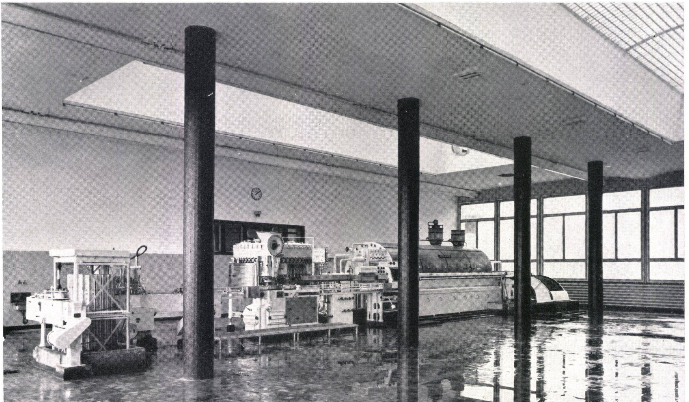
Abfüllhalle. Oberlichter Glasbeton, Säulen und Wände mit Betonemail behandelt, Boden mit Gußasphalt isoliert, darüber Klinker. An der Decke Kranbahn, darunter von rechts nach links: Einmündung des Steilförderers, Flaschenwaschmaschine, Kontrolle, Abfüll- und Verschlußmaschine, Etikettiermaschine. Salle de mise en bouteilles. Filling unit.
