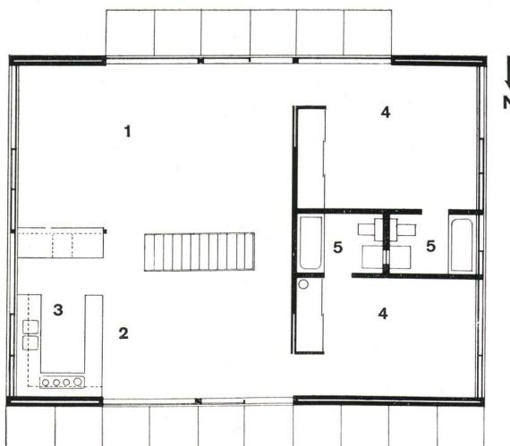
Grundriß Erdgeschoss / Plan du rez-de-chaussée / Ground floor plan 1:150
