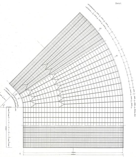
. Teilansicht der Hallenkonstruktion. Geschweißte Stahlkonstruktion mit verschraubten Montagestößen.
