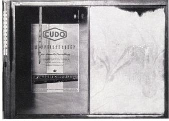
Diese Aufnahme von einer Versuchs-Diese Aufnahme von einer Versuchs-anordnung wurde gemacht bei einer Außentemperatur von + 15° und einer Innentemperatur von - 15°. Die normale Fensterscheibe rechts ist ganz mit Eis bedeckt, während die Cudo-Doppelscheibe links ihre klare Durchsichtigkeit be-
