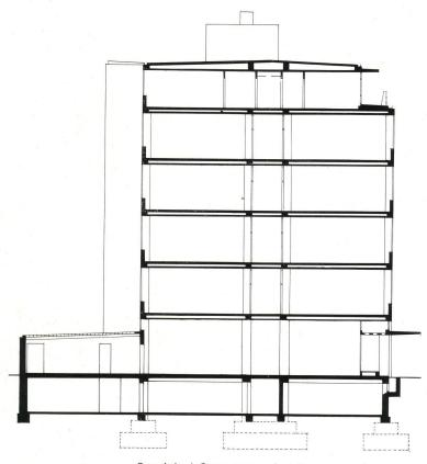
Querschnitt / Coupe transversale / Transverse section 1:250
