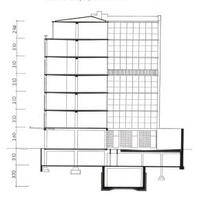
Die Fußböden im ganzen Hause bestehen aus schwimmendem Zementestrich auf Torfoleum und sind mit grünem Korklinoleum bekleidet. Die elektrischen Installationen und Telefonleitungen sind leicht erreichbar in einem vor den Fenstern bündig im Boden eingelassenen Kabelkanal untergebracht.
