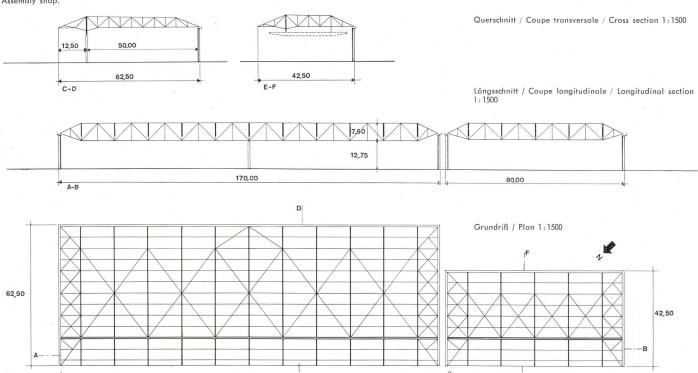
Durch günstige Querschnittgestaltung kann man, vorsichtig beurteilt, mit 25 Prozent Gewichtsersparnis rechnen. Dies sollte die Architekten und Ingenieure veranlassen, sich vermehrt mit dem Leichtstahlbau, der ästhetische Bauformen gewährleistet, zu befassen.
