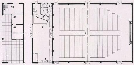
Grundriß Obergeschoß/Plan de l'étage supérieur/Upperfloor plan 1:500.
