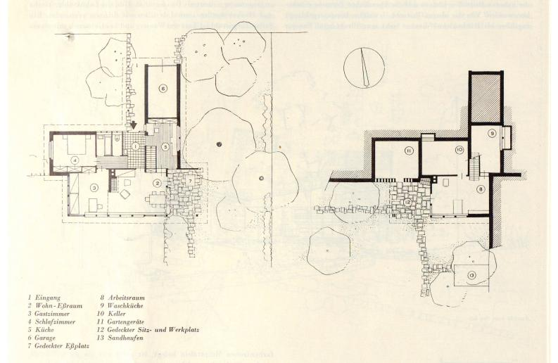
Gliederung der Baukuben, deren Strenge die aus der Konstruktion sich ergebende Farbigkeit entgegensteht (rotes, unverputztes Backsteinmauerwerk und helle Holzwände). Verschiedene Gartenebenen, deren Bepflanzung dem Maßvollen der Gegend angepaßt ist, sichern dem Haus seine Beziehung zu der umliegenden Landschaft.
