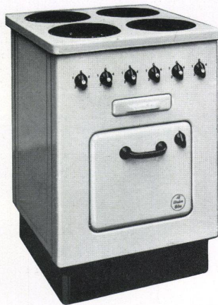
Elektroherd mit 4 Kochplatten / Brat- und Backofen / Auffangmulde und Schublade / Herdplatten-größe 585 x 585 mm / Höhe des Herdes 800 mm Gewicht zirka 65 kg. Cordon Bleu, Lausanne
