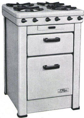
Le Réve – Gasherd Modell G – 536. 4 Gaskochstellen / Spülmulde mit kleiner Auf- fangschublade / geschlossener Tellerwärmer / ein Backofen, sockelartiger Abschluß / feuervermailliertes Stahlblechgehäuse / Herdgröße: 550 mm breit 610 mm tief, 810 mm hoch. Le Réve S.A., Genève
