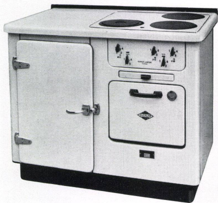
«Elcalor»-Kühlschrankherd, elektrische Partie mit 3 oder 4 Kochplatten, Normalbackofen sowie links Kühlschrank 90 Liter Nutzinhalt mit Rotationskompressor-Kühlaggregat, emailliert elfenbein. Firma Elcalor A.G., Aarau
