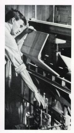
Das Grundelement besteht aus gebogenem Sperrholz von 19 mm Dicke.
