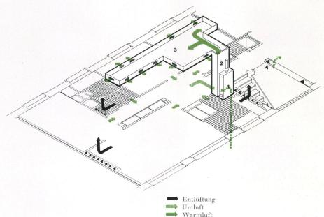
Schema der Heizanlage Schema de l'installation de chauffage Plan of the heating plant
