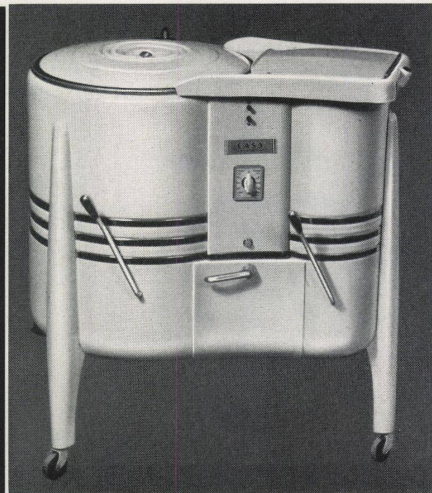
3 Fahrbare elektrische Waschmaschine «Easy». Gewicht: 86 kg. – Maße: 90 × 65 × 100 cm. – Motor: \frac{1}{4} PS 220 Volt. – Fassungsvermögen: 3,5 kg Trockenwäsche. Firma Großenbacher & Co., Zürich
