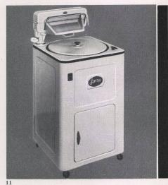
11 Fahrbare Elektro-Waschmaschine «Servis». Gewicht: 78 kg. – Maße:  $56.5 \times 56.5 \times 85.5$  cm. Motor:  $\frac{1}{4}$  PS 220 /230 Volt. – Fassungsvermögen: zirka 4 kg Trockenwäsche.
