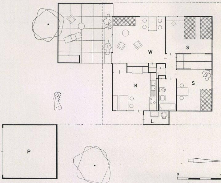
Ein kalifornisches Elementen-Haus mit Wand- und Ausbauelementen diverser Breite. Sanitärbloc für Küche - WC - Bad. Wandschränkelemente. Großzügige Planlösung in Kreuzform ohne Korridore. Die Wände bestehen aus gepreßter Papiermasse, mit zwei Aluminiumplatten bedeckt.
