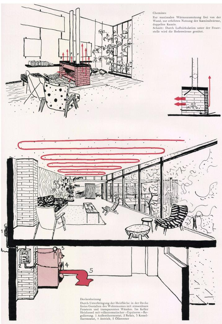
beim Anheizen schneller, was ebenfalls eine Brennstoffeinsparung von 20–50 % ergibt. Beide Systeme bestehen im Prinzip aus dem Heizkessel, den Radiatoren, dem Expansionsgefäß, das an höchster Stelle liegen muß, den Leitungen und den Armaturen. Das gute Funktionieren der Schwerkraft- wie Pumpenheizung hängt von richtiger Bemessung aller Teile, guter Entlüftung und einwandfreier Rohrführung ab.
