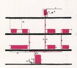
Schema einer Schwerkrafts-Wasser-Heizung
