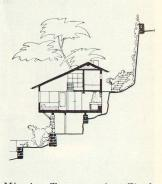
Mit seinen Terrassen, seinem Ziegeldach und den zurücktretenden Stützmauern ist der Bau in den steilen Uferhang gebunden.
