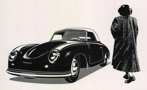
Luftgekühlter Boxermotor im Heck, 4 Zylinder, 1,3 Liter, 6,55 Steuer-PS, 44 Brems-PS. Maximaldrehzahl 4200 U/min; Maximalgeschwindigkeit zirka 150 km/std bei hervorragend sicherer Straßenhaltung.
