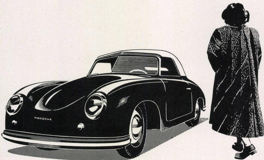
Luftgekühlter Boxermotor im Heck, 4 Zylinder, 1,3 Liter, 6,55 Steuer-PS, 44 Brems-PS.
