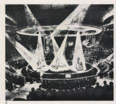
Kreisgröße – das Maximum sein und die größte Distanz zwischen dem entferntesten Zuschauer bis zum äußeren Umriß der Spielfläche nicht mehr als 3 bis 4 Meter sein sollte. Daraus ergibt sich ein Raum für zirka maximal 300 bis 350 Zuschauer. Der Aufführungsstil, der auf direkten Kontakt zwischen Schauspieler und Publikum und auf eine gewiße Intimität zielt, setzt maximale Hörbarkeit voraus; auch daraus ergibt sich die Grenze für die Größe des Raumes.
