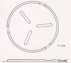
Teilansicht und Grundriß einer Sandboxe / Vue partielle et plan d'une caisse à sable / Part view and plan of a sand box
