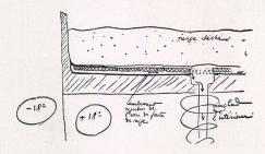
Beim Flachdach läßt man den Schnee ruhig liegen. Das Abflußrohr befindet sich im Innern des Gebäudes, wo das Schmelzwasser nicht wieder gefrieren kann.
