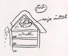
Die Zentralheizung mit ihren Radiatoren durchwärmt das ganze Haus bis zu den Ziegeln. Der Schnee beginnt zu schmelzen, und das Wasser rinnt über die Ziegel.
