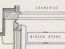
Grundriß und Ansicht bei geöffnetem Fenster und heruntergelassenen, geschlossenen Kirsch-Storen
