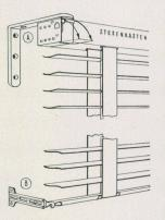
Wandbefestigung der Kirsch-Sto-ren bei großer Ausladung. Kasten-träger A ist vorne aufklappbar und Storenkasten kann herausgehoben werden. **B** Arretiervorrichtung zum Einhängen
