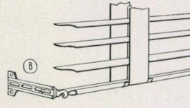
Wandbefestigung der Kirsch-Storen bei großer Ausladung. Kastenträger **A** ist vorne aufklappbar und Storenkasten kann herausgezogen werden. **B** Arretiervorrichtung zum Einhängen
