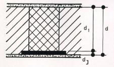
Weist eine Wand infolge von Säulen, Nischen, Hohlräumen usw. an verschiedenen Stellen ungleiche Zusammensetzung auf, während die Wärmeübergangszahlen  $a_1$  und  $a_2$  über die ganze Oberfläche gleich angenommen werden können, so müssen, wenn gleiche Oberflächentemperaturen bestehen sollen, die Summen der Wärmedurchlaßwiderstände 1/β überall gleich sein.
