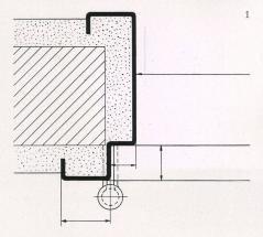
Türzargen der Metallbau AG. Zürich. Diese werden im Rohbau versetzt und erhalten die Farbe der Wand. Die Türe selbst kann aus Naturholz sein.
