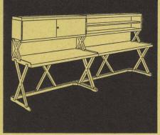
Eine gute Illustration zu unseren wachsenden Wohneinheiten sind, auf das Gebiet des Möbelbaus angewendet, die kombinierbaren Strub-Gestelle, aus einzelnen Elementen zusammengesteckt und mit Splinten fixiert. Die Grundelemente sind Tablare, Streben und Füße. Anstelle der Seiten- und Rückstreben können Seiten- und Rückwände, sowie Türen verwendet werden. Trennwände, Schubladen und verstellbare Tablare sind Zusatzteile.
