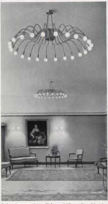
Beleuchtung eines Pelzgeschäftes, Kombination von Fluoreszenz- und Glühlampen mit betont vornehm dekorativer Wirkung. Ein Teil der Fluoreszenz-Lampen (reines Tageslicht) kann zur Erzielung des «Winter-Effekts» separat geschaltet werden. Baumann, Koelliker AG., Zürich
