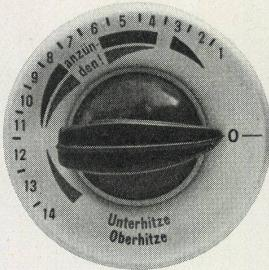
Schon lange war es der Wunsch, den Schalter des Backofenhahnes in die Skala der Backofenregulierung einzubauen und gleichzeitig das Ausbauen des Hahnenreibers von vorne, ohne Demontage des Herdes zu ermöglichen. Die Lösung dieses Problems ist in der neuen Backofenregulierung gelungen und entspricht einem weitern Fortschritt in der Konstruktion der Gasherde.
