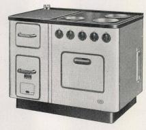
Kombinierter Haushaltherd SURSEE Typ 403 Z bestehend aus Elektroabteil und einem Feuerungsabteil mit eingebautem Heizkessel für eine Zentralheizung einer Etagenwohnung oder eines kleineren Einfamilienhauses. Zusätzlich kann eine Heizschlange für Boiler eingebaut werden, so daß der Herd gleichzeitig zum Kochen, Heizen und zur Warmwasserzubereitung dient.
