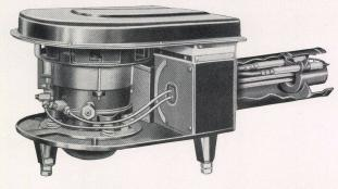
Der vollautomatische General Electric Vorbau-Ölbrenner kann für jeden Zentralheizungskessel von 2 bis 13 m² Heizfläche verwendet werden. Er bedarf keiner Wartung, indem das Heizöl selbst vor der Verbrennung alle rotierenden Teile schmiert. Es besteht nur ein Typ, der jedoch für drei Leistungsbereiche durch Auswechslung der Düsen verwendet werden kann.
