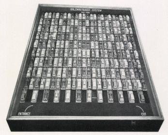
Bei mechanischem Parkieren nach Baldwin-Auger 228 Wagen, d. h. 90 % mehr 228 voitures en parking méchanisé Baldwin-Auger, c.à.d. 90 % de plus
