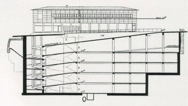
Schnitt durch die 5 unterirdischen Hallengeschosse und das Abfertigungsgebäude auf dem
