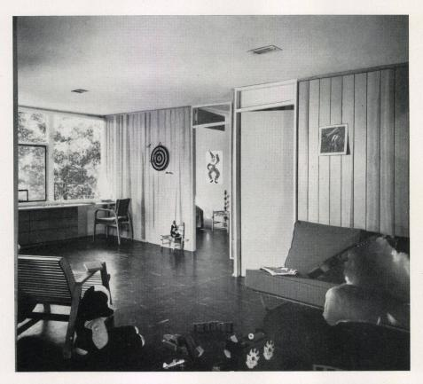
Wohnzimmer der Kinder. Die Innenwände sind unabhängig von der Tragkonstruktion und können dadurch bei einer später wünschbaren neuen Raumunterteilung beliebig versetzt werden.
