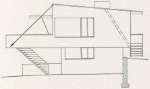
Seitenansicht von Norden. Das Gewicht des an Stahlkabeln aufgehängten Balkons wird von der als Querrahmen ausgebildeten Außenwand aufgenommen.
