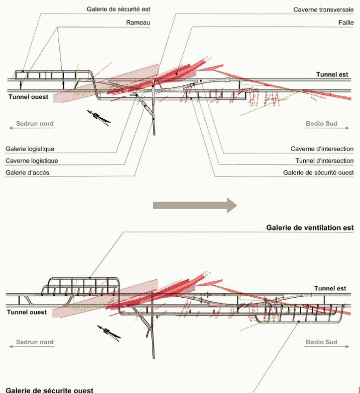
Fig. 1 : Schéma de la station multifonctionnelle de Faido : situation initiale (en haut) et après modification (en bas)
