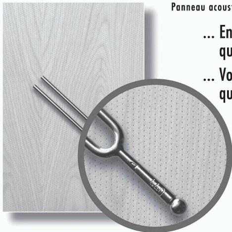
La surface de cet élément en bois retient l'attention par les très petits trous, d'un diamètre de seulement 0,5 mm. La micro perforation est à peine visible, même à courte distance. RONDOLLO® avec une surface ouverte de seulement juste 5,7%, atteint effectivement, une incroyable absorption de sons. Le coefficient NRC d'absorption de sonorité, correspond au chiffre formidable de 0,8.
