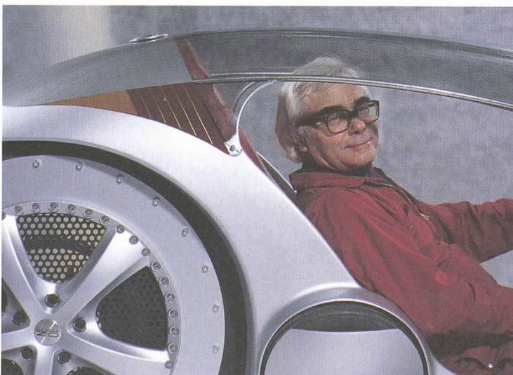
Fig. 1 : Franco Sbarro au volant de son « mono trace » à deux roues, l'un des premiers véhicules conçus avec une roue motorisée, ici à l'arrière
