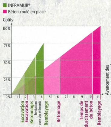
Temps de construction considérablement réduit; 20 à 25 % d'économie par rapport aux murs en béton coulés en place.
