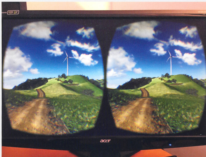
Scène VR d'un parc éolien conçue à l'aide du logiciel CryEngine et basée sur des données SIG. On peut observer ici le mode d'écran partagé pendant une présentation avec les lunettes VR d'Oculus Rift SDK2. (Photo Wissen Hayek et al., 2016) https://doi.org/10.14627/537612012
